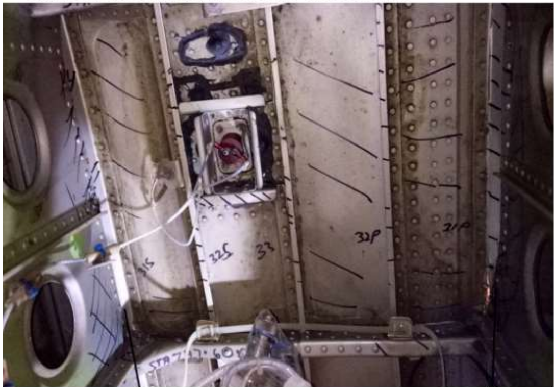
RH Stringer 31S Keel Web Damage
