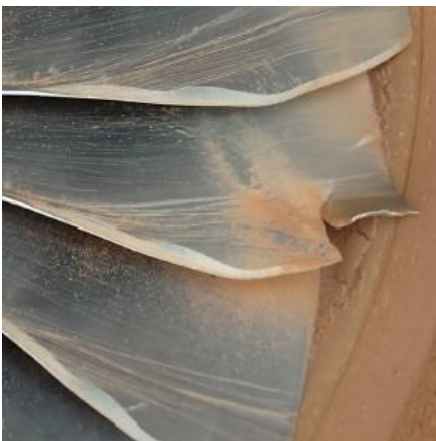
Fig 32: Bent fan blade
